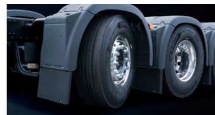
타이어 소모를 줄이고 회전 반경을 줄여주는 5축 리프팅 & 조향 시스템.
