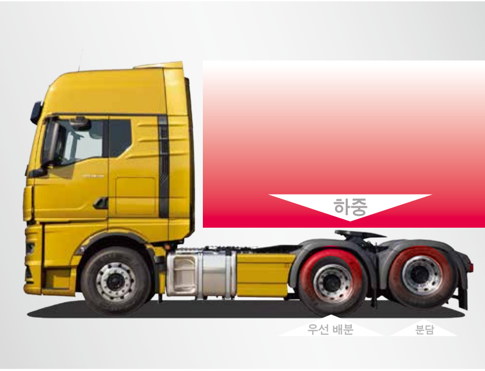
스마트 구동축 하중배분 기능 적재하중으로 인해 3축이 하강되더라도 2, 3축에 균등배분이 아닌 2축 우선 하중 배분을 통해 등판 시 슬립 발생을 줄이고, 편리한 출발을 지원 (전 차종)
