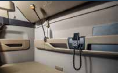
구스넥 램프 및 컨트롤러
